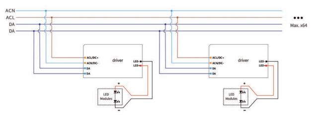
Dimmerazione Push il driver passa automaticamente in modalità di controllo Push
